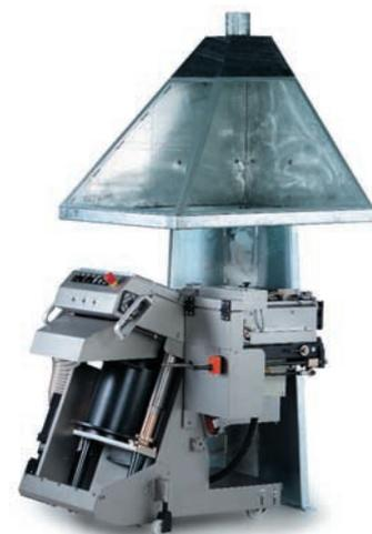
L'**unità di pulitura** dell'unità di incollaggio al poliuretano garantisce una pulitura sicura e curata in base alle normative vigenti.
